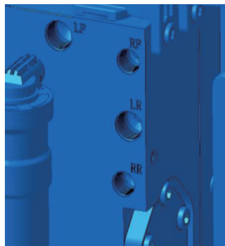
图9 集成式线控制动模块的防错标识
