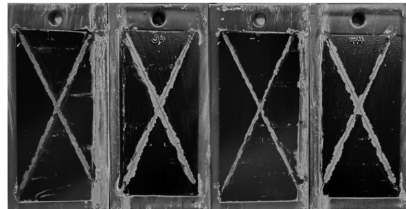
图1 BMD板配套涂层经500 h中性盐雾试验
