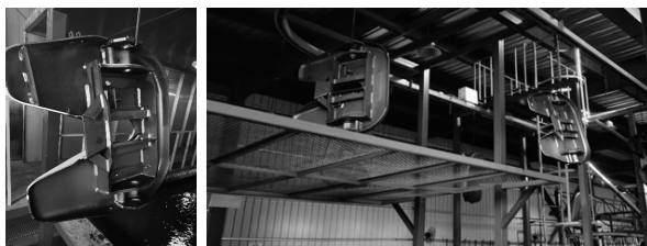
(c)为SA-207/3无磷转化工艺在某一零部件厂阴极电泳生产线现场应用
