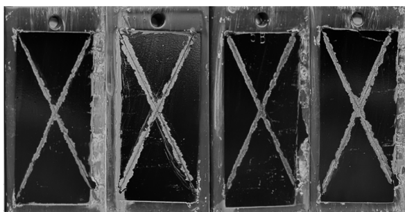
图2 EPS板配套涂层经500 h中性盐雾试验后照片
