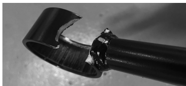
图4 失效开裂套管
