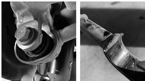
图2 控制臂耐久试验失效
