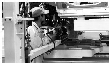
图23 后扭转梁支架与车身紧固拧紧工具
