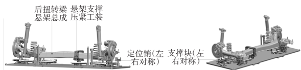
图8 扭转梁式后悬架托盘工装
