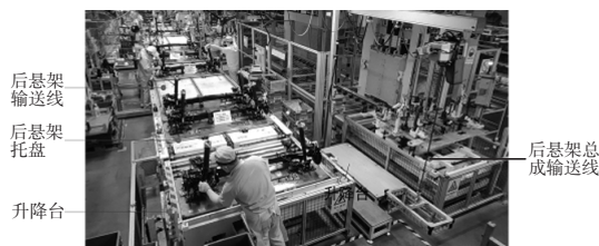
图6 后悬架分装线
