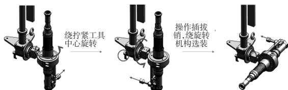
图18 辅助力臂的工具夹持机构
