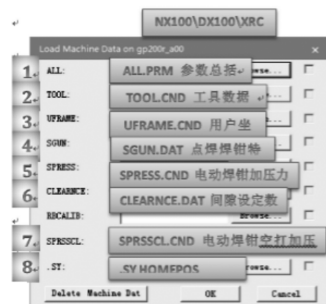
图11 MOTOMAN 机器人控制器中各配置文件含义
