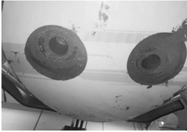
图9 增加垫圈后压盘下表面状态
