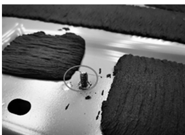
图12 LASD残胶干涉螺栓
