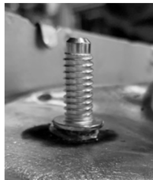
图3 焊钉熔池偏移
