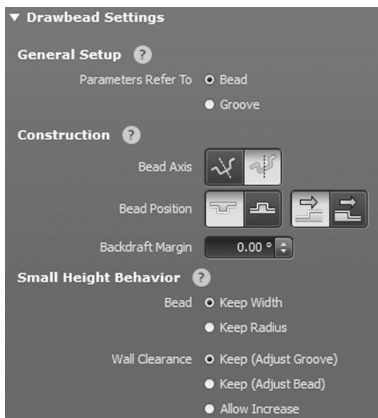
图 1 AutoForm 设置拉延筋形式界面
