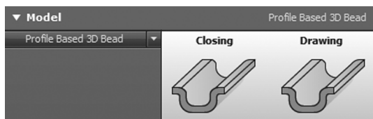
图 5 AutoForm 应用的拉延筋模型
