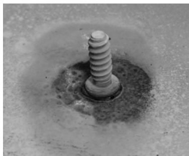
图2 喷显影剂后的螺柱
