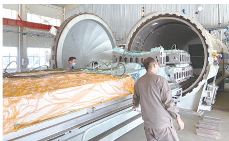
图5 碳纤维复材制件送入热压罐过程
