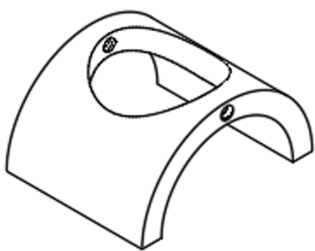
图4 杆部外圆检测工装
