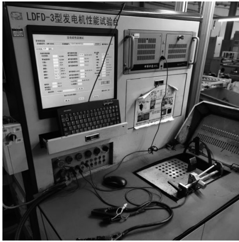
图12 朗迪LDFD-3汽车试验台
