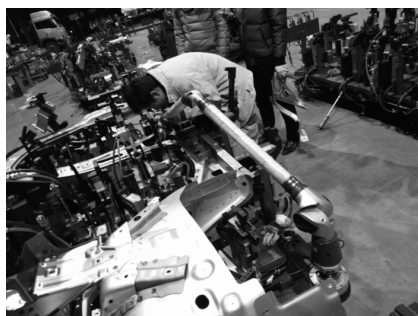
图8 在线匹配在某车型侧围夹具上的应用
