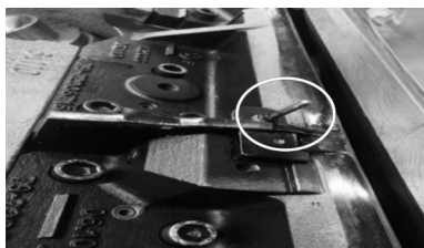
图39 顶料销刮料屑
