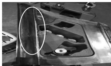
图41 压料板压料过宽
