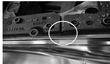
图32 镶块结合间隙
