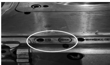
图 64 凸模标记刮料屑
