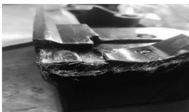
图49 弹簧刀导向间隙大切出料屑
