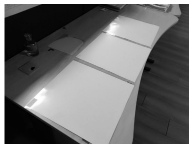
图9 原漆和再生RO水以1:1、10:1、10:0.5混合所做的喷涂样板
