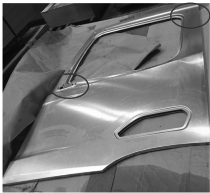
图2 铝合金车门外板试制件
