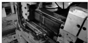
(b)掉落的氧化皮导致设备停机
