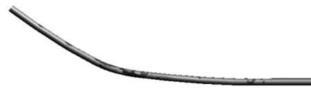
图5 A柱上加强板热胀管梁弯管成形分析结果
