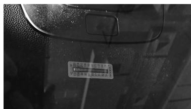
图4 夏季暴晒后仪表板的温度
