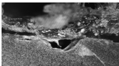
图7 显微镜150倍胶水层与骨架虚接
