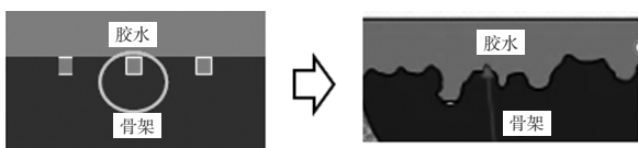
(a)表面平滑的骨架状态 (b)设想增加骨架粗糙度状态
