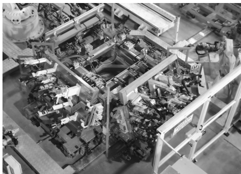
图18 转台4+n柔性切换系统在生产示范应用
