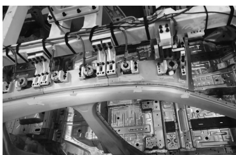
图 12 胎膜下压使顶盖与侧围外板贴合
