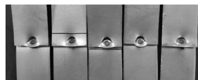
(b) I_{max} 剪切拉伸断裂样(54#~58#)
