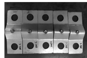
(d) I_{max} 十字拉伸断裂样(59#~63#)
