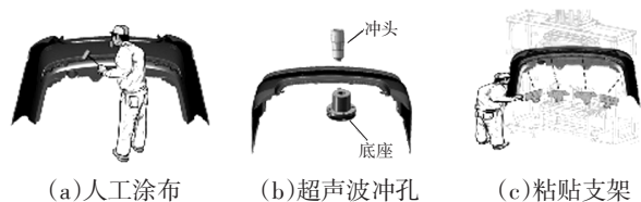
图1 超声波冲孔粘支架工艺流程
