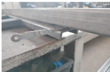
(d)长纵梁左端变形检测
