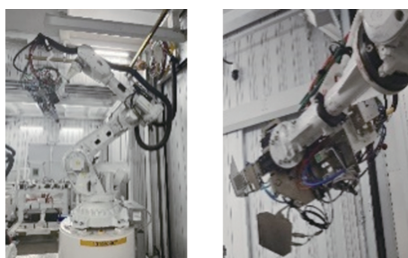
图1 激光焊接系统
