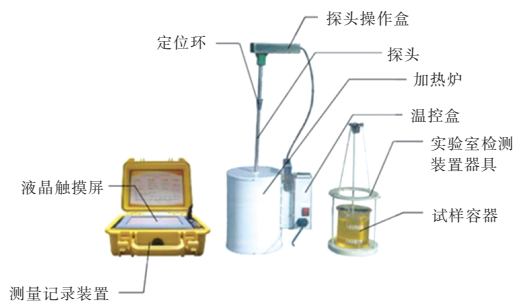
图 1 冷速测量装置
