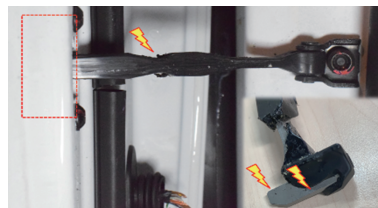
图 3 左前门限位臂T字头处包塑开裂情况
