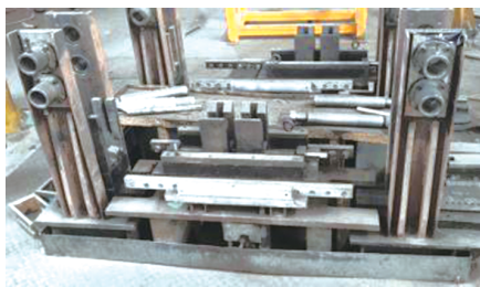
图2 原正穿式工装台
