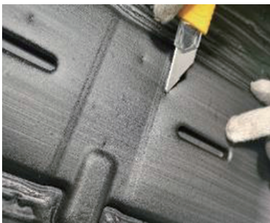
图 3 出现碳化的吹脚风道
