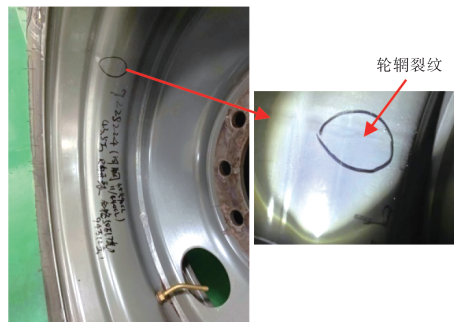
图16 径向疲劳轮辋闪光焊缝开裂
