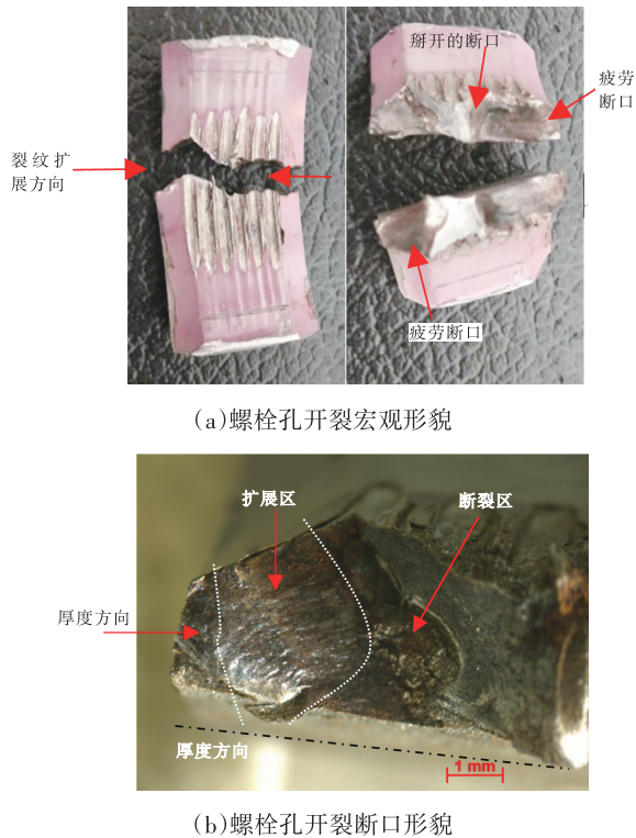
图4 螺栓孔开裂宏观形貌和断口形貌
