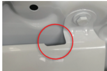
图 13 优化后的翼子板装车验证
