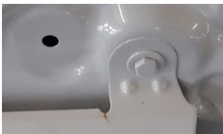
图 1 翼子板路试的开裂位置
