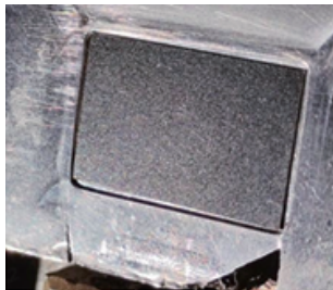
图3 宏观状态下金属垫片状态
