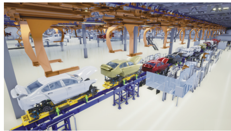
图6 某主机厂数字孪生合车线
