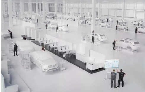
图5 某主机厂AGV式主线
