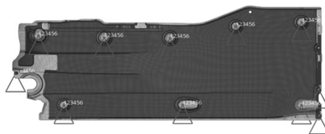
图 2 车底护板有限元网格划分
