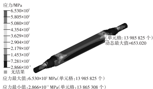
图 10 2.5 倍满载荷条件下的车轴件应力分布
