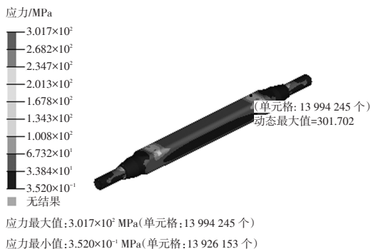
图 9 1.0 倍满载荷条件下的车轴件应力分布
