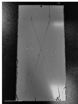
图8 AS13/13热成形钢油漆试验
