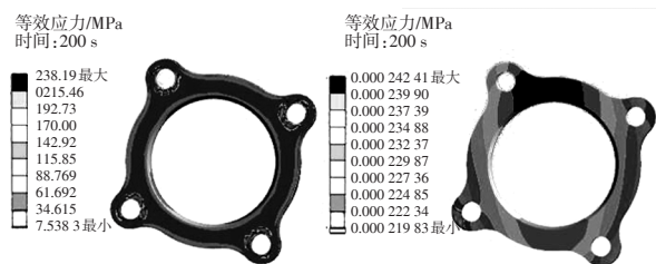
图 13 160 A, v=5 mm/s 应力与应变结果
