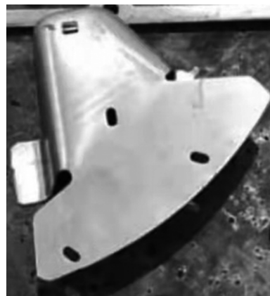
图 17 某车型侧轨前底板
