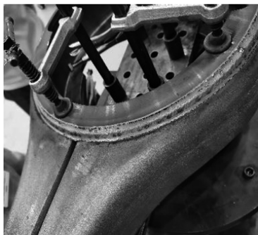
图 13 加强圈焊缝成形
