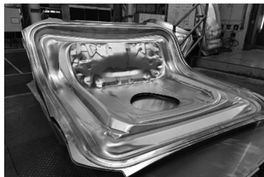
图14 下压料力1 000 kN制件状态
