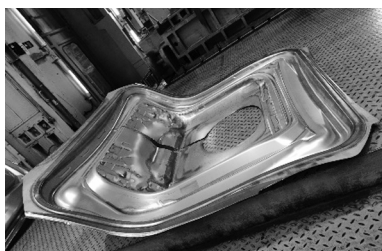
图13 下压料力600 kN制件状态
