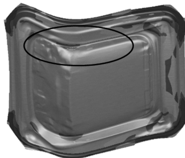
图9 无落料孔制件成形结果
