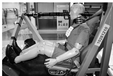
图5 某项目驾驶员座椅第50百分位假人后撞试验
