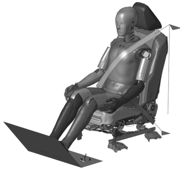
图6 某项目驾驶员座椅后撞仿真模型
