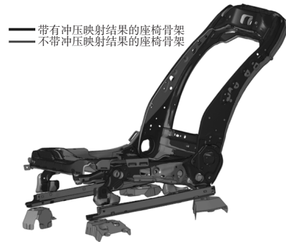
图8 座椅靠背最大变形位置对比
