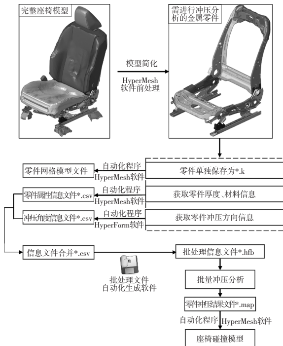
图7 冲压映射批处理技术使用方法
