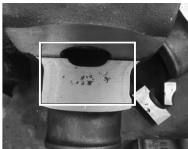
图8 零件内部缺陷
