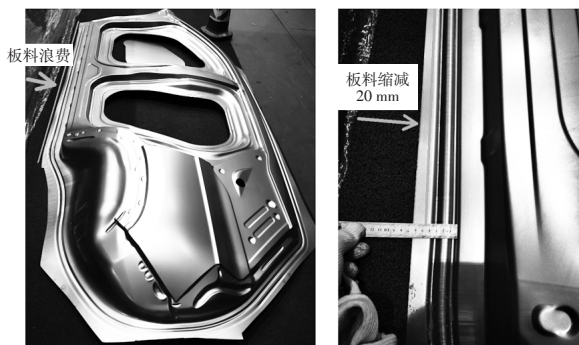
图 19 侧围板料边界状态
