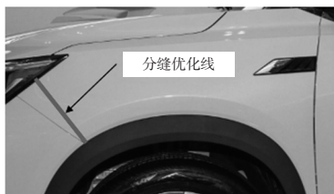
图3 翼子板与前保分缝设计
