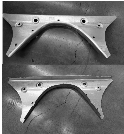
图 25 横梁的实际冲压结果
