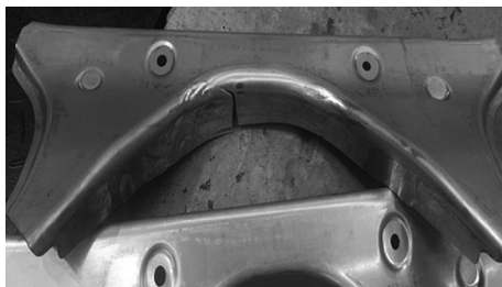
图 2 横梁在翻边成形时边部开裂
