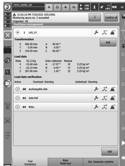
图8 PFO B8板安装机器人工具坐标系
