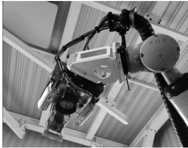
图 9 PFO 45°连接块安装
