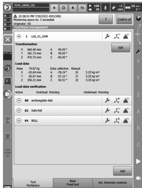
图 12 PFO 45°连接块安装机器人工具坐标系
