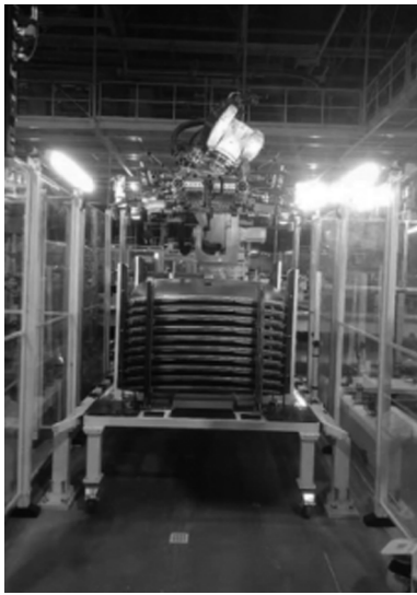
图9 机器人通过机械视觉抓取顶盖
