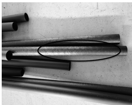
图5 PA66挤出管的橘皮现象
