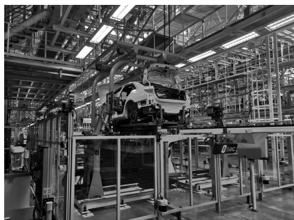
图2 整体式自动合装工艺
