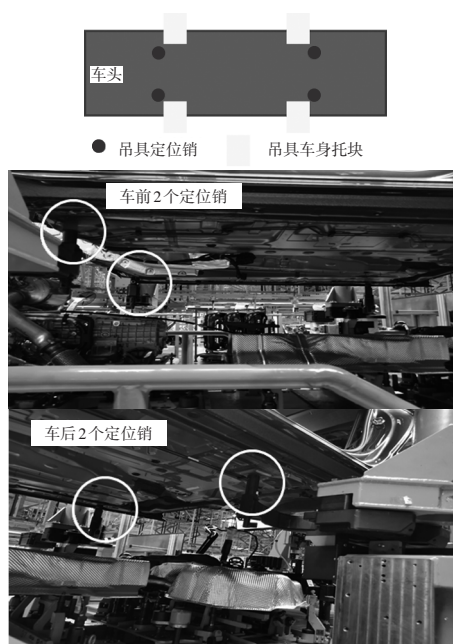
图3 4销孔配合车身-吊具定位系统
