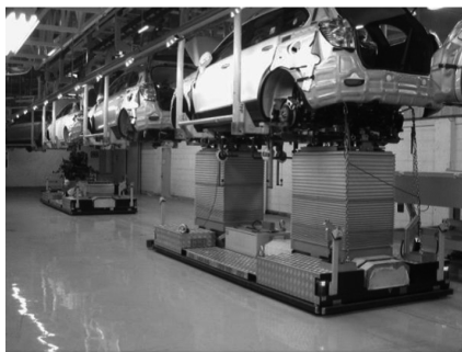
图1 整体式半自动合装工艺
