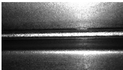
图25 合格激光焊缝
