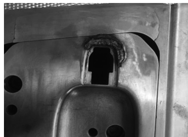
图 23 后序 OP30 试验位置凸模烧焊加高示意
