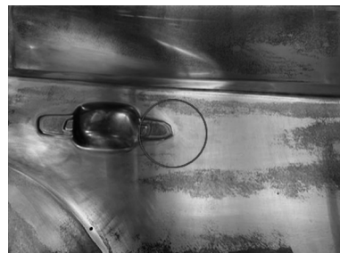
图13 拉延凹模着色检查示意
