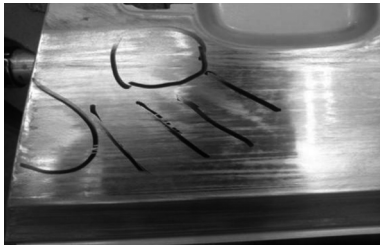
图2 机械手放件位置不合理导致缺陷示意
