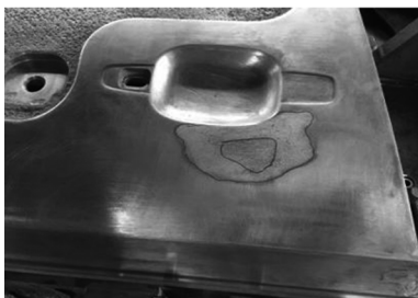
图46 凸模涂树脂胶增加凸模高度示意
