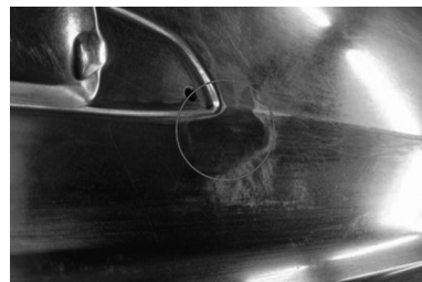
图7 缺陷位置对应的凸模型面示意
