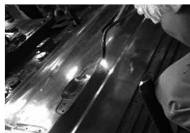
图8 气焊烘烤拉延凸模示意
