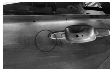
图14 拉延凸模着色检查示意
