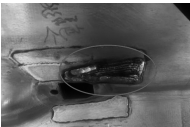
图 34 压料板烧焊加长示意
